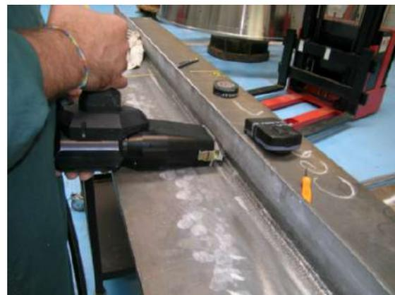
**Figure 22 : Équipement de martelage par ultrasons (UNP) de SONATS et son utilisation**
