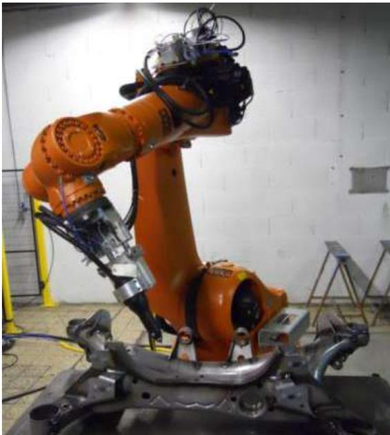
**Figure 40 : UNP robotisé sur un châssis de véhicule automobile**
