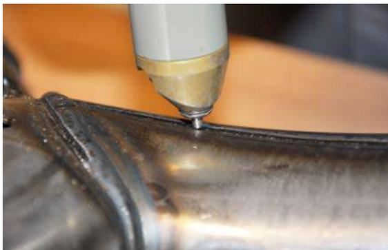
Figure 15 : Martelage par ultrasons du pied de cordon
