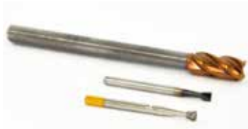
Figure 2 : (de haut en bas) un outil coupant 4 mm de diamètre, un outil coupant de 1.8 mm et une fraise abrasive diamantée de 1.8mm
