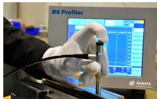
Mesure non destructive RS Profiler par courants de Foucault
