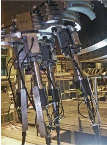
Grenailage de précontrainte de la rainure de l'arbre avec un équipement portable
