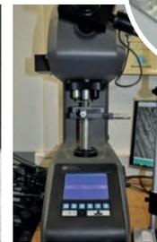
Observation micrographique de joints soudés, mesure de dureté et analyse de surface
