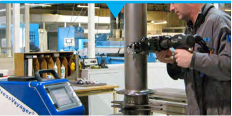
实现stressonic® 技术的超声波喷丸 处理 解决方案
