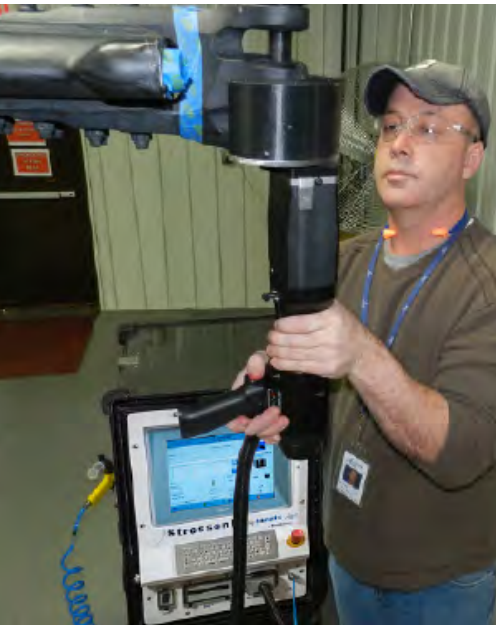
使用强化版STRESSVOYAGER® USP 进行叶片备件维修
